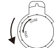
①ムーブメントカバーを「OPEN」の方向に回してカバーをはずします。
