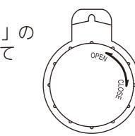
④ムーブメントカバーを「CLOSE」の方向に回して、しっかりと閉めて下さい。
